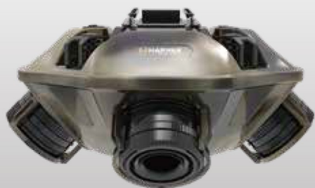
五镜头倾斜相机模块
